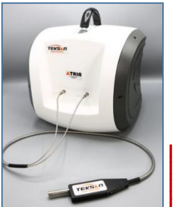
دستگاه آنالیز رامان پرتابل با دو طول موج ساخت شرکت تکسان که با حمایت ستاد فوتونیک و مواد پیشرفته تولید شده است. کاربرد در صنایع و علوم مختلف، مبارزه با مواد مخدر، باستان شناسی، گوهر شناسی و ...
